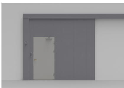
S88 kan utstyres med en innfelt gangdør. Brannklasse opp til EI 2 90/EW120.
