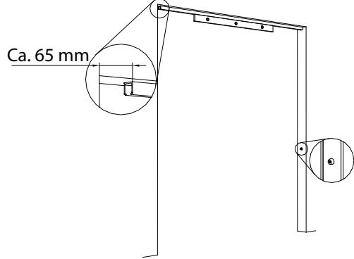
1. Monter skinnen i den horisontale veggbjelken. Kontroller at den er i vater. Skinnelengden må tilpasses slik at vognene lett kan føres inn i eller ut av skinnen. Monter dørstopperen på den indre veggbjelken.
