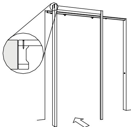
3. Monter anslagskarmen (ved tofløyet dør er det ett sidestykke) med et av overstykkene samt et av sidestykke. Legg merke til at overstykket skal skrus fast i sidestykke på en slik måte at det lett kan demonteres fra utsiden. Monter karmen i åpningen.
