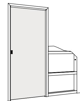
8. Bygg bjelkeparti i veggen. Fritt åpningsmål i bjelkeveggen skal være minst 67 mm. Avslutt med å montere veggskiver og gerikt.
