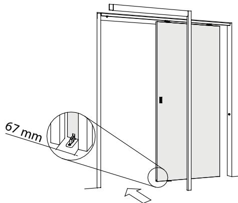
7. Monter det gjenværende overstykket og sidestykket. Kontroller at avstanden mellom sidestykke er 67 mm.
