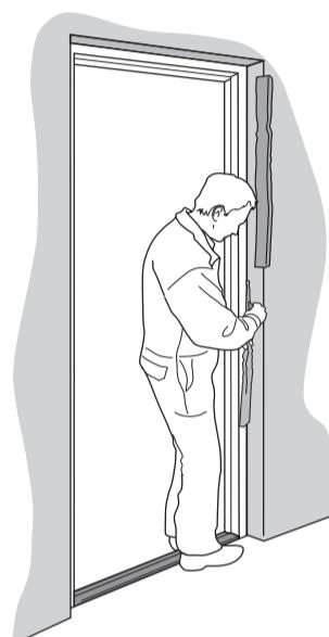
Hele spaltebydelen mellom karmen og vegggen skal dyttes med ikke-brennbar isolasjon, euroclass A1, ev. A2-s1 d0.
